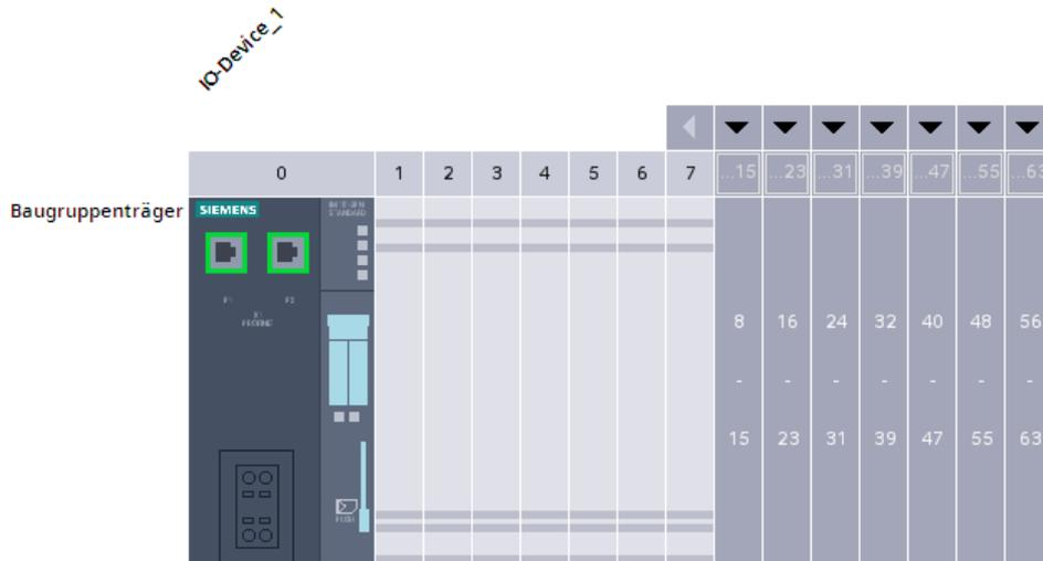
Auf Steckplatz 1 wird als erstes das Powermodul eingefügt.
