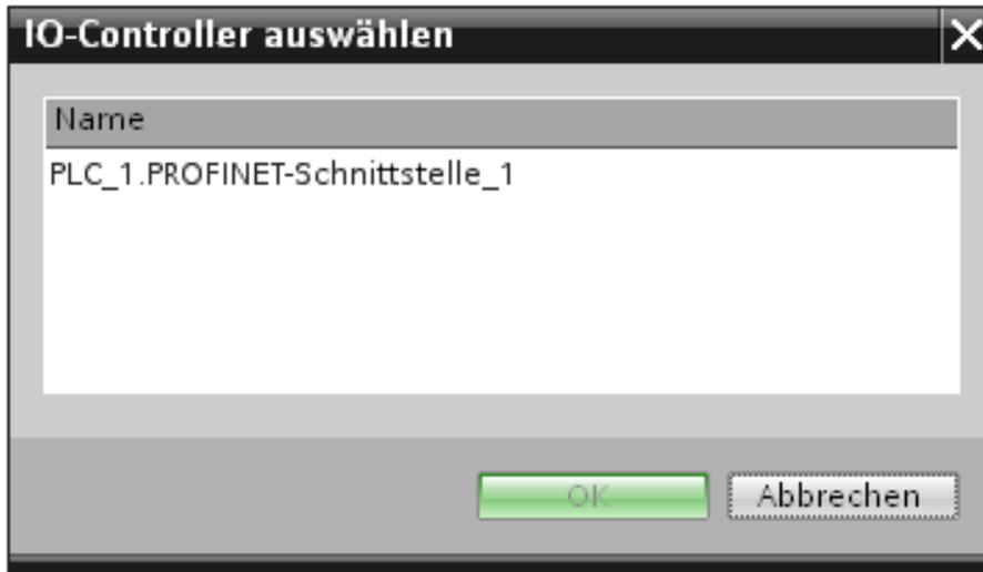
Markieren Sie die Schnittstelle und bestätigen Sie mit „ok“. Anschließend wird die ET 200S an das Netz angeschlossen.
