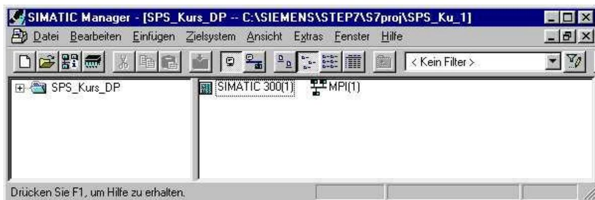
Fügen Sie eine Station ein und diese ein Rack und auf Steckplatz 1 ein Netzteil 5 A ein.
