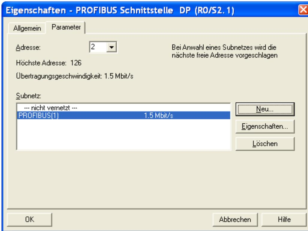
Bestätigen Sie mit ok. Die CPU wird mit der Busleitung eingefügt.
